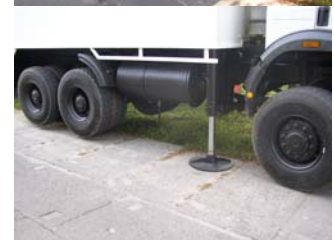
Durchführung einer Drucksondierung zur Feststellung der Lagerungsdichte
