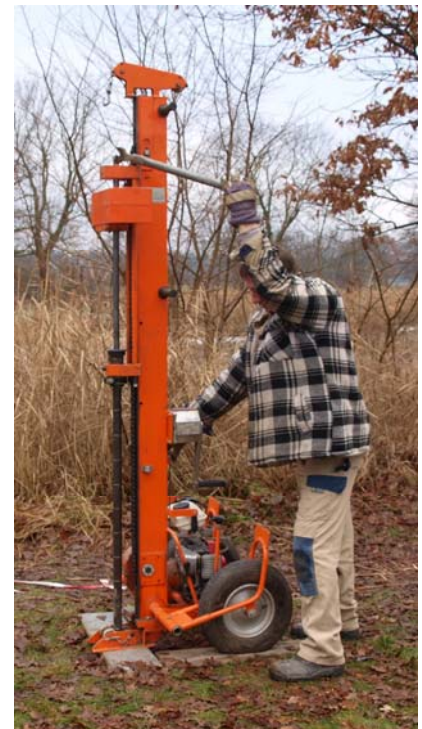
Rammsondierung mit der Schweren Rammsonde (DPH)
