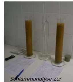
Schlamm-analyse zur Ermittlung der Kornverteilung
