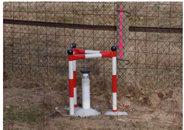
Ausbau eines Bohrlochs zur 2" Grundwassermeßstelle zur Entnahme von Wasserproben
